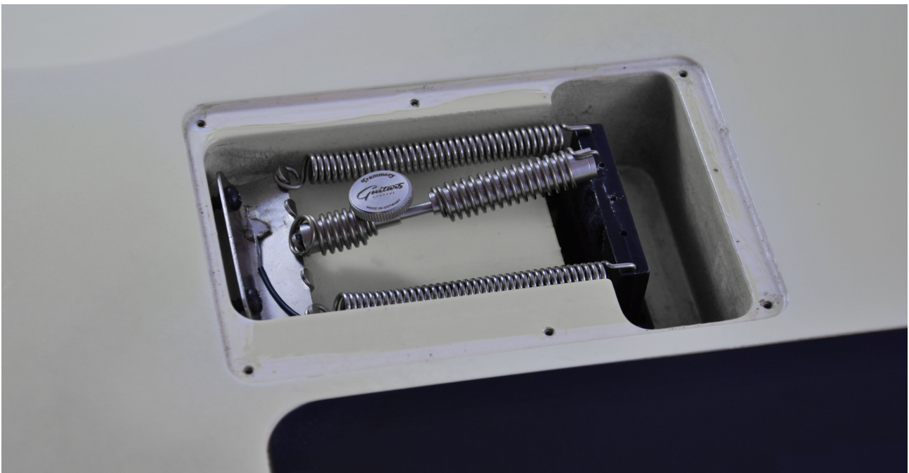
Abbildung 2: Einbau des Tremmory System
