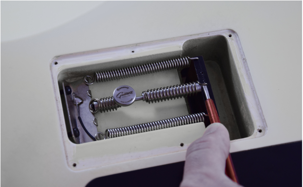
Abbildung 3: Das Tremmory in den Tremoloblock einhängen
